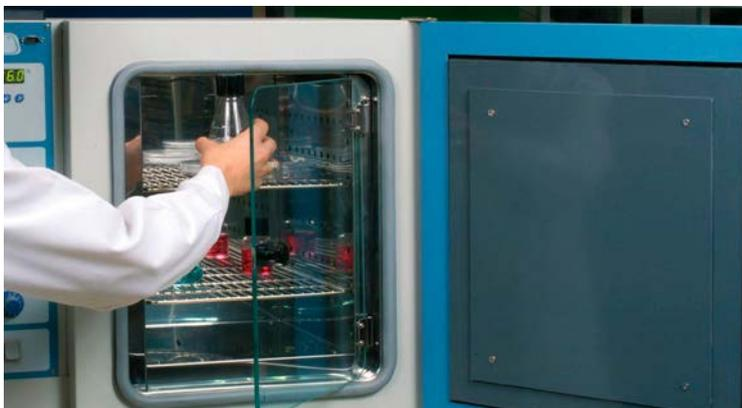
Nota: Per una omogeneità ottimale di temperatura è necessario distribuire ragionevolmente lo il carico nello spazio, non superando il 70% del volume utile.
