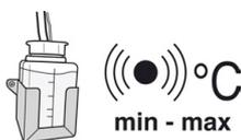
Sonda allarme temperatura zavorrata per simulazione prodotto
